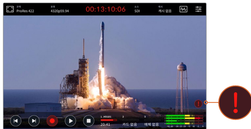
미디어의 문제가 감지되면 LCD 화면 오른쪽 하단 모서리에 느낌표가 나타납니다.
