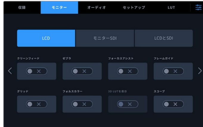
LCDまたはSDIモニタリング・オプションのオン/オフをタップして切り替え。
